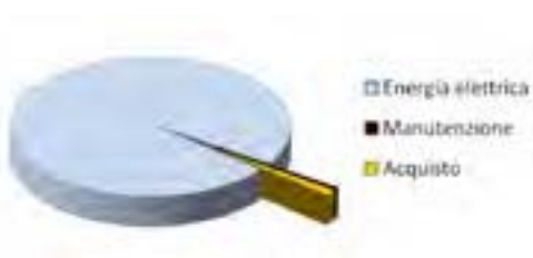
Fig. 2 - ripartizione costi acquisto e gestione di un motore elettrico
