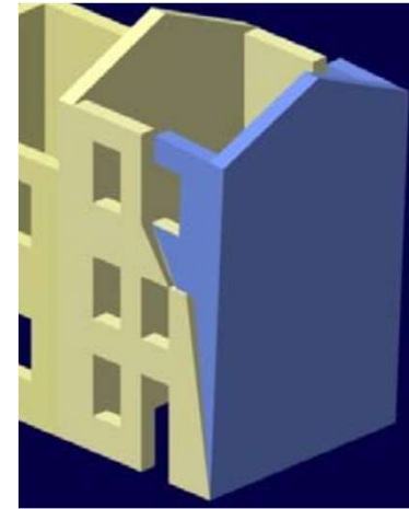
Meccanismo di ribaltamento composto di parete
